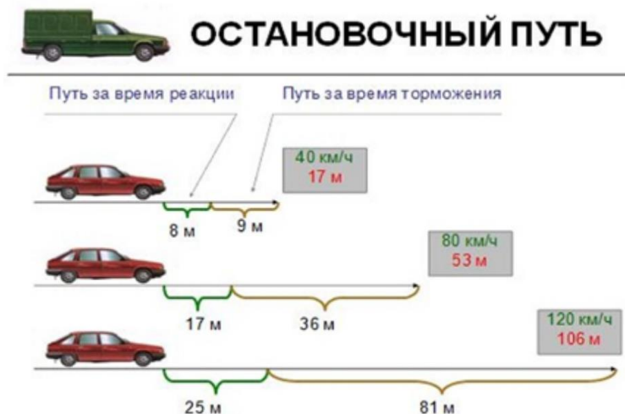
Рисунок 18. Составляющие остановочного пути
